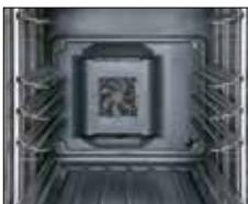
Abkühlzeit: 90 Minuten bis auf 4,4°C (getestet bei einer Raumtemperatur von 23°C). Wiederherstellzeit: 10 Minuten, bis die Temperatur nach 30-sekündigem Öffnen der Tür wieder erreicht ist.
