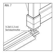
10. Hochdichte Camshelving Mobileinheiten gemäß den jedem Kit beiliegenden Anweisungen zusammenbauen. Die hochdichten Camshelving Mobileinheiten anheben und in die Spuren einsetzen (2 Personen erforderlich); hierbei sicherstellen, dass sich die Rollen ungehindert in der erhöhten Laufschiene bewegen.
