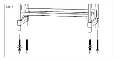
9. An den beiden Enden der Schiene jeweils eine feststehende Einheit anbringen, deren Vorderseite zu den Schienen zeigt. Alle Justierfüße so einstellen, dass die Einheit flach auf dem Boden aufsitzt. Die stationären Laufschienen-Endplatte unter die stationäre Laufschienen-Plattenkappe schieben (siehe Abb. 6). Die ½ Zoll (1,3 cm) Sechkantschraubenmutter anbringen und mit einem Rollgabelschlüssel festziehen. Hierdurch wird die feststehende Einheit an den Schienen befestigt. (Siehe Abb. 7).
